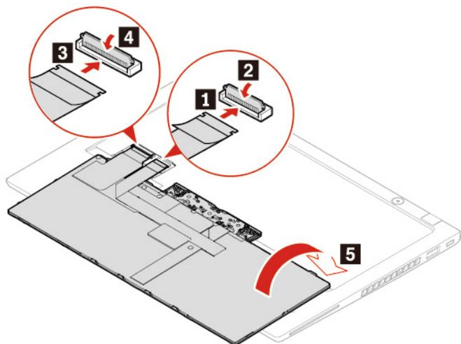
10. Setzen Sie die Tastatur wie abgebildet in die Tastaturblende ein. Vergewissern Sie sich, dass sich die vordere Kante der Tastatur (die zum Bildschirm weisende Kante) unter der Tastaturblende befindet.
