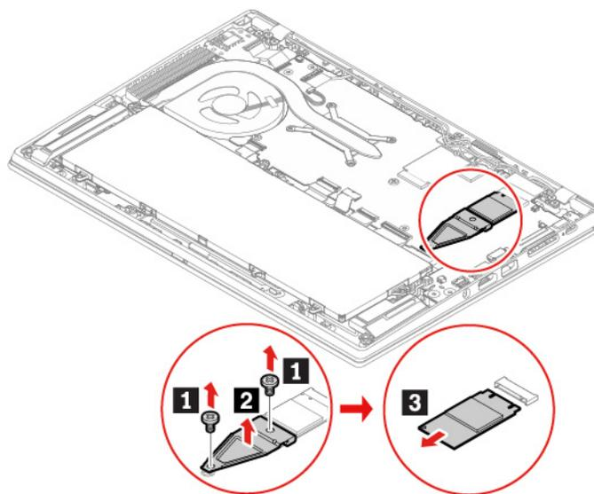
6. Gehen Sie wie folgt vor, um ein neues M.2 Solid-State-Laufwerk zu installieren:
