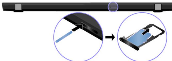
2. Achten Sie darauf, dass die neue microSD-Karte richtig ausgerichtet ist. Setzen Sie eine neue microSD-Karte so in den Einschub ein, dass die Metallkontakte nach unten zeigen. Setzen Sie den Einschub in den nano-SIM-Kartensteckplatz und in den microSD-Kartensteckplatz ein, bis er hörbar einrastet.
