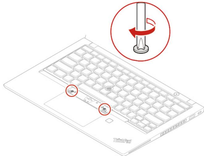
13. Nehmen Sie die neuen TrackPoint-Tasten aus der Verpackung der neuen Tastatur heraus. Setzen Sie die TrackPoint-Tasten, wie dargestellt, ein.
