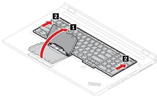
7. Schwenken Sie die Tastatur leicht nach oben, wie durch den Pfeil **1** dargestellt. Wenden Sie die Tastatur dann in die von Pfeil **2** angegebene Richtung.
