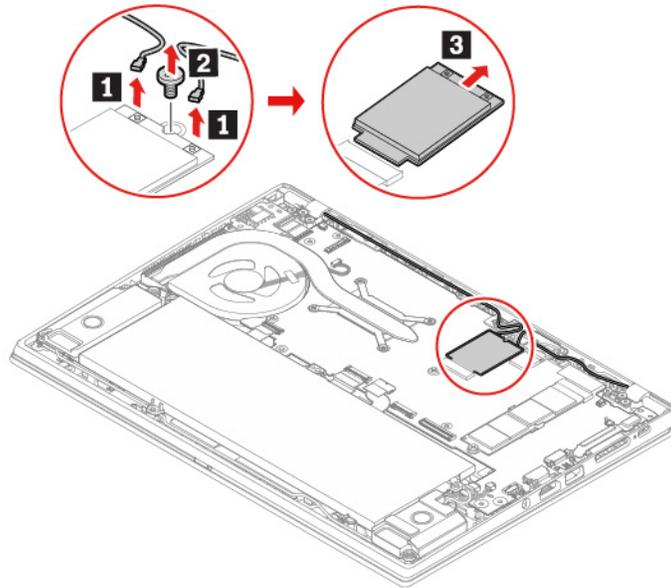
6. Installieren Sie eine neue Karte für drahtlose WAN-Verbindungen, indem Sie wie folgt vorgehen:
