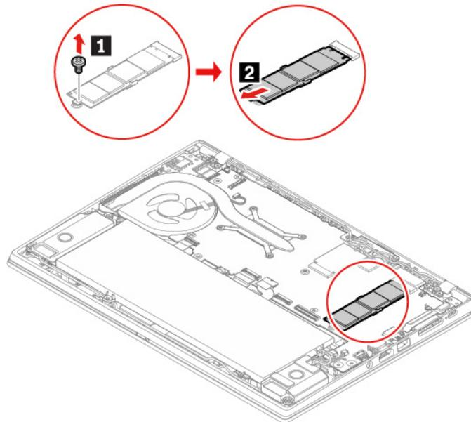
7. Gehen Sie wie folgt vor, um ein neues M.2 Solid-State-Laufwerk zu installieren:
